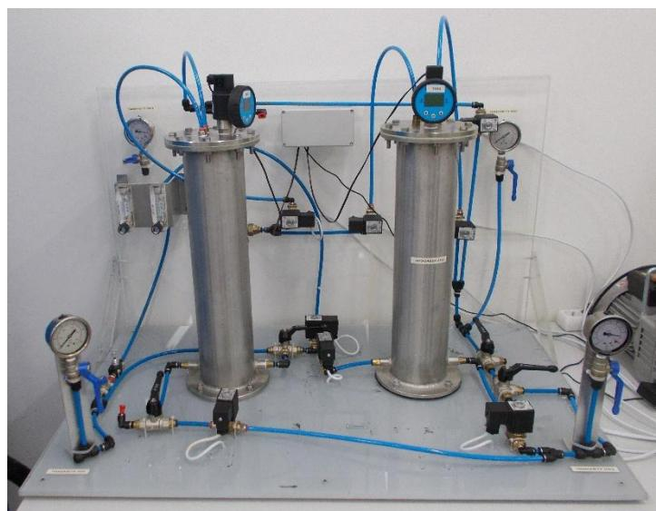
Obr. 7 Laboratorní zařízení PSA.
