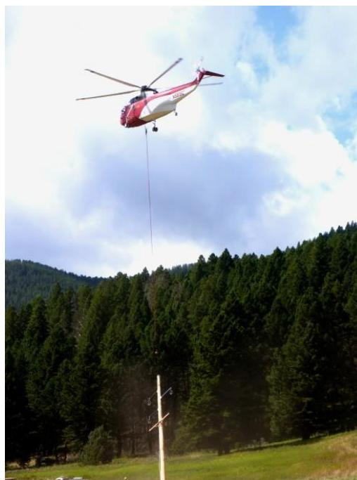
Obr. 2: Montáž stožiarov prenosovej linky „Jack Rabbit – Big Sky 161 kV Transmission Line“ (USA) vrtuľníkom Sikorsky S-61, 2013 (Fiske a Dell 2015)
