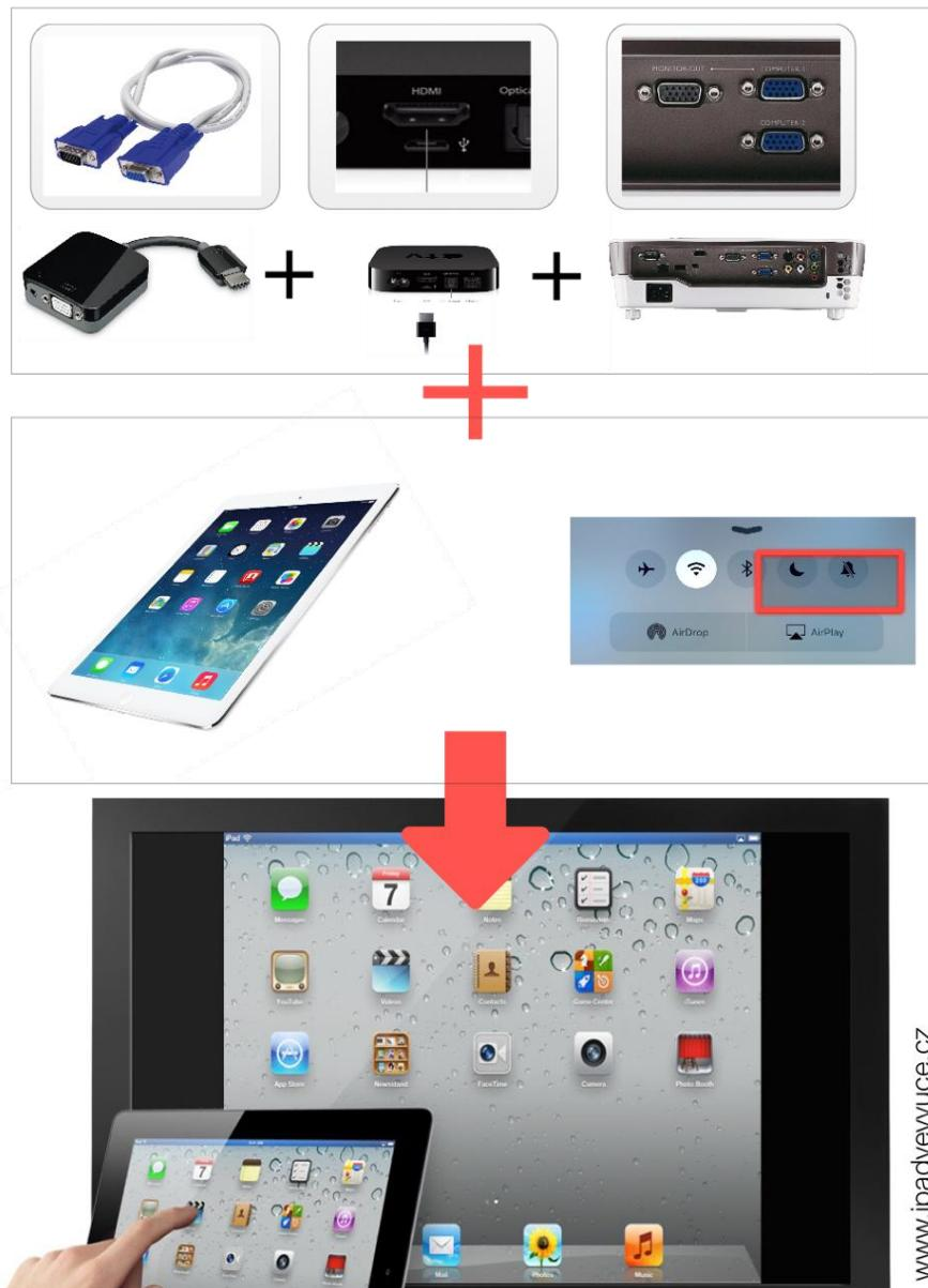
Obrázek 2 - Schéma zapojení Apple TV s VGA
