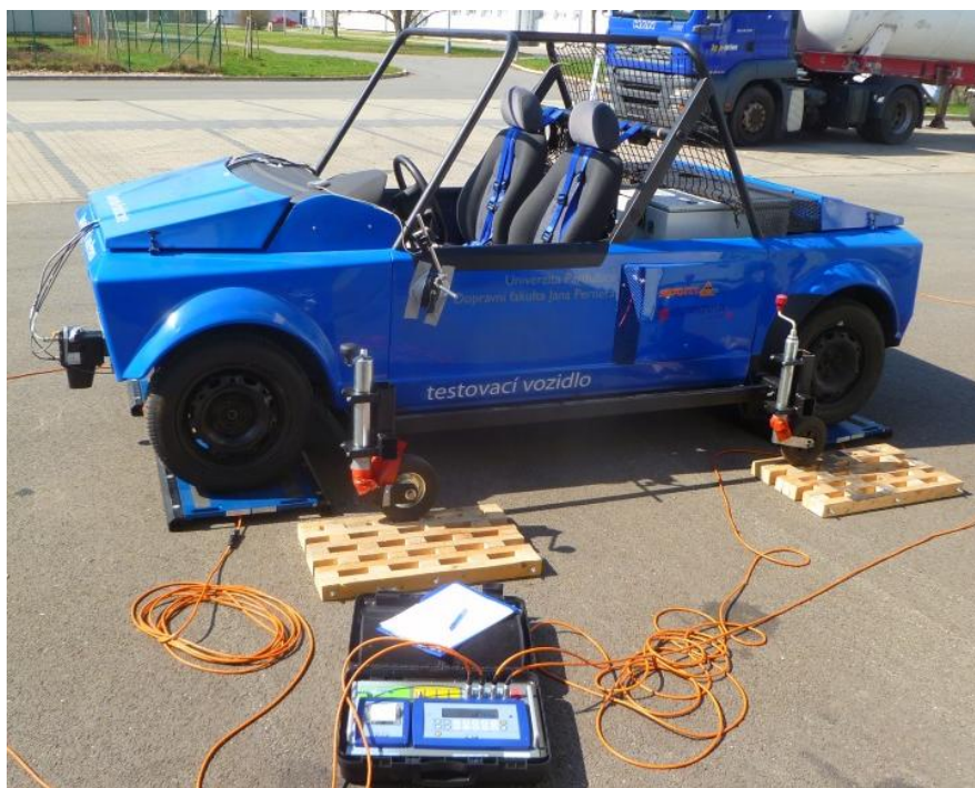
Obrázek 4 Nastavení potřebného zatížení alternativního SkidCar (autor)
