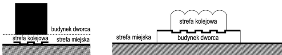
Rys. 4, 5. Dworzec z budynkiem recepcyjnym nad i pod torami (opracowanie własne)
