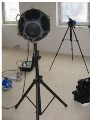
Obrázek 2 – Měření stavební neprůzvučnosti
