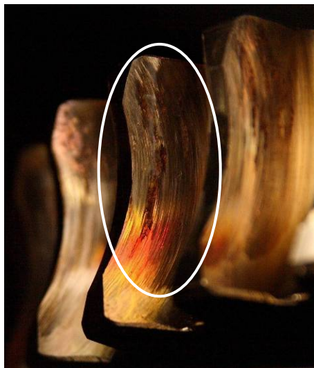
Obr. 4 Povrch bokov zubov závitovkového kola na konci prvej fázy experimentu
