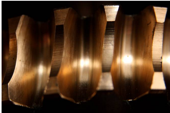
Obr. 3 Povrch bokov zubov závitovkového kola nepoužitej prevodovky
