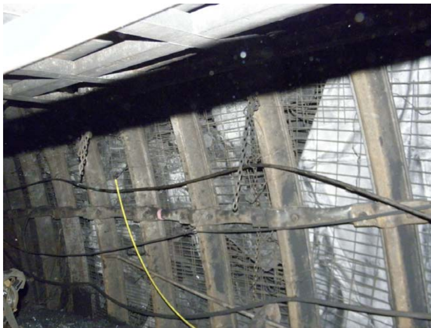
Obrázek 4 – Nálepy uhelného prachu na pravém boku třídy 112 7453, pohled od čelby
