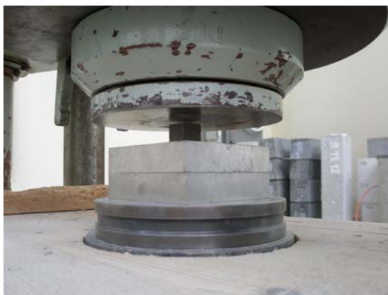
Obr. 1 Krychlička cementové pasty v lisu před zkouškou pevnosti
